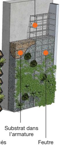
Substrat dans l'armature
